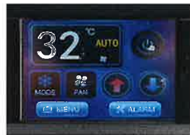
リモコンも付属し、現在温度を確認したり、温度の設定ができる。家庭用と同じインバーター方式のコンプレッサーを採用しているので、設定温度に近づくにつれて省電力となる
